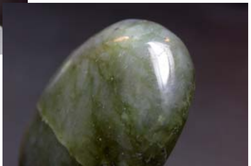
Abb. 9 Der Labradorit hat wie die meisten Kristalle eine triklin Kristallstruktur.
