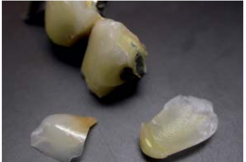
Abb. 24 Ein amorphes Material bricht ähnlich wie eine Glasscheibe in Scherben.
