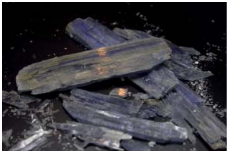
Abb. 14 Kennt man die kristallographische Textur eines Kristalls so kann man ihn spalten. Die Anisotropie verleiht diesen Disthen- fragmenten (Cyanit) ein schmelzähnliches, lichtoptisches Wechselspiel.
