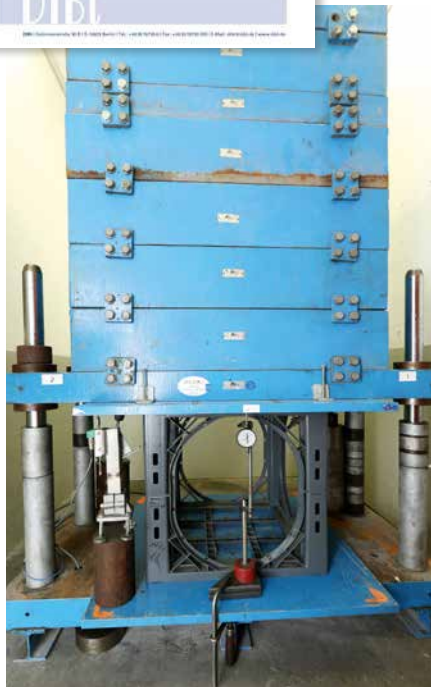
Langzeitversuch mit vertikaler Extrembelastung
