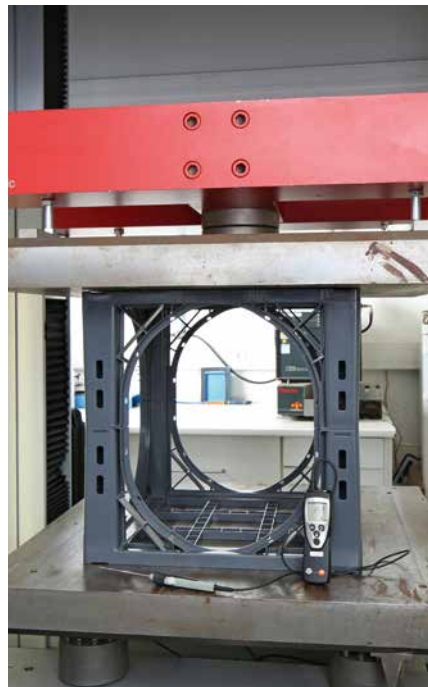
Kurzzeitversuch mit vertikaler Belastung
