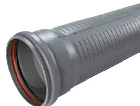
> Spülrohr oben geschlitzt, inkl. Muffe, hochdruckspülfest und kamerabefahrbar
