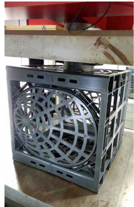
Druckbelastung der Seitenplatte über Stempel
