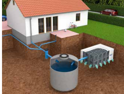
Versickerungssystem mit D-Raintank 3000® als Überlaufversickerung für Regenwasserspeicher mit vorgeschaltetem Reinigungsschacht. Die Verbindungen bestehen aus HS®-Rohren für Regenwasser.
