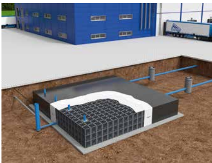
Speicher- oder Retentionssystem mit D-Raintank 3000® und anschließender Folienummantlung mit vorgeschalteten Reinigungsschächten und nachgeschaltetem Überlaufschacht für die dauerhafte Speicherung von Regenwasser.
