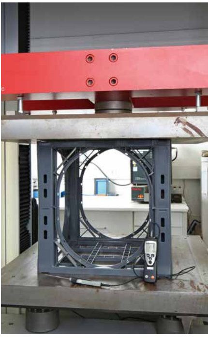
Kurzzeitversuch mit vertikaler Belastung
