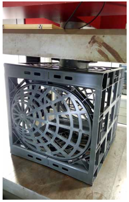
Druckbelastung der Seitenplatte über Stempel
