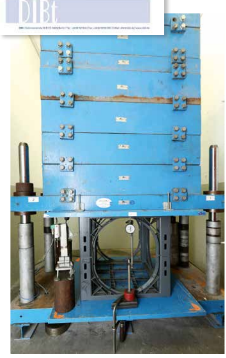
Langzeitversuch mit vertikaler Extrembelastung
