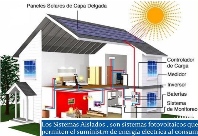
Los Sistemas Aislados, son sistemas fotovoltaicos que permiten el suministro de energía eléctrica al consumidos sin la necesidad de una conexión a la red eléctrica de un proveedor externo (CFE), lo cual proporciona energía exclusivamente proveniente de la luz de sol
