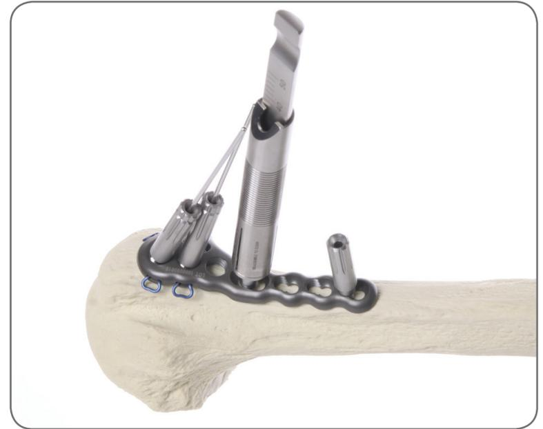
Con el destornillador hexagonal o en estrella, enrosque un tornillo cortical de 3.5 mm de diámetro a través del orificio perforado de la placa. Con frecuencia, esto contribuirá a la reducción de la fractura (reducción de contrafuerte).
