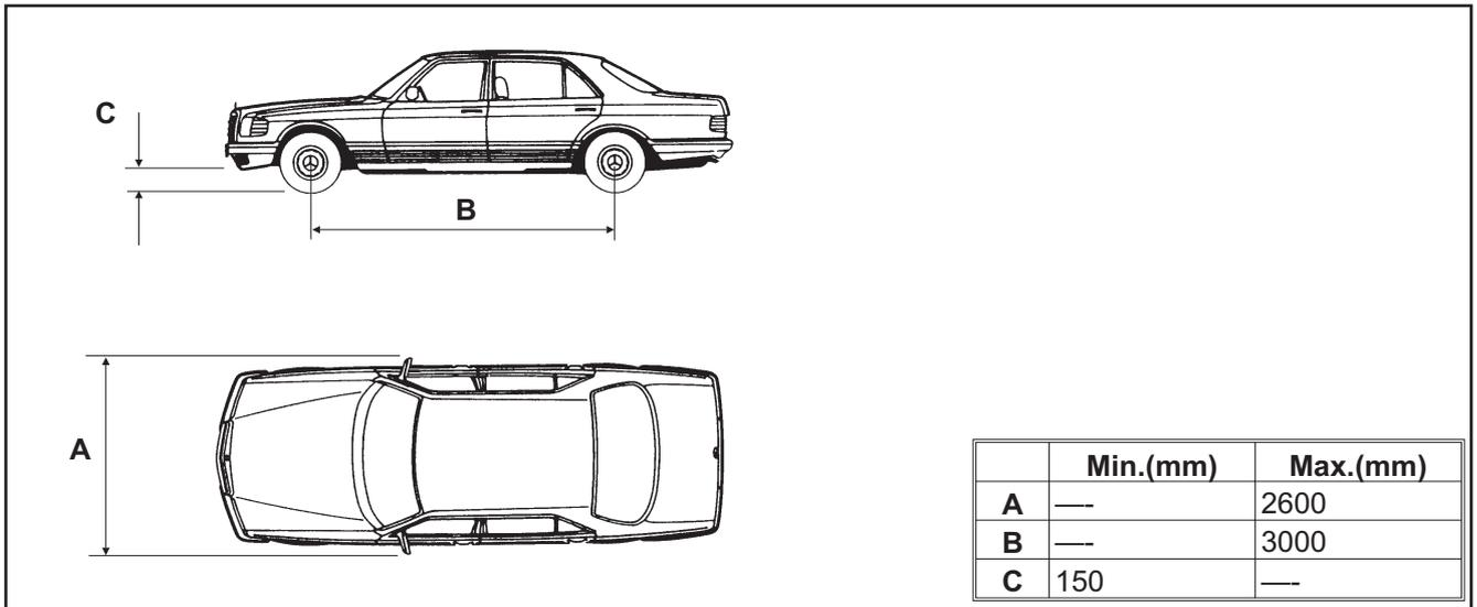
Fig.11 Misure minime e massime
