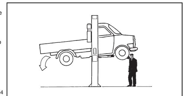
Fig.24 Rischio di spostamento del veicolo
