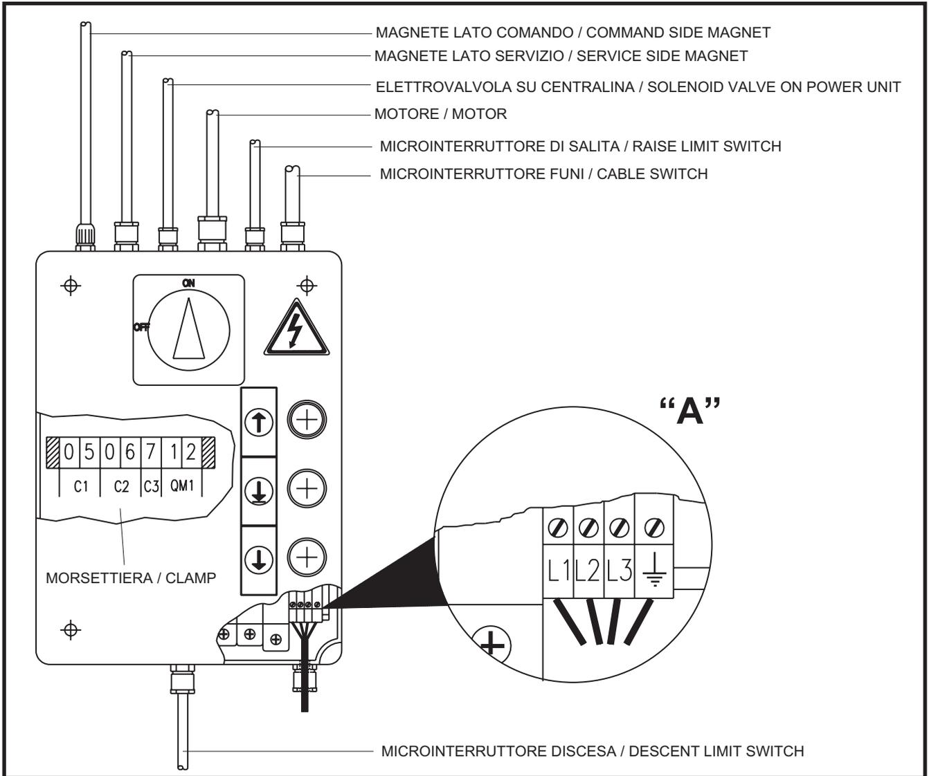
Fig.49 Collegamenti elettrici del quadro
