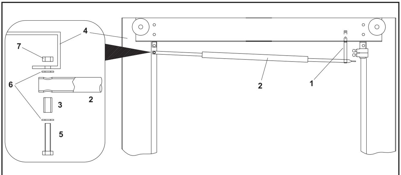
Fig.47 Montaggio barra finecorsa
