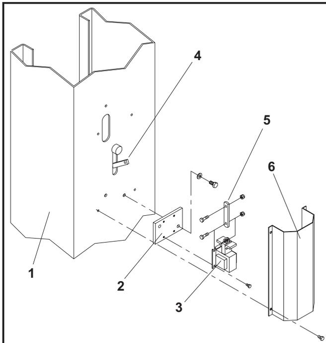
Fig.46 Montaggio elettromagneti
