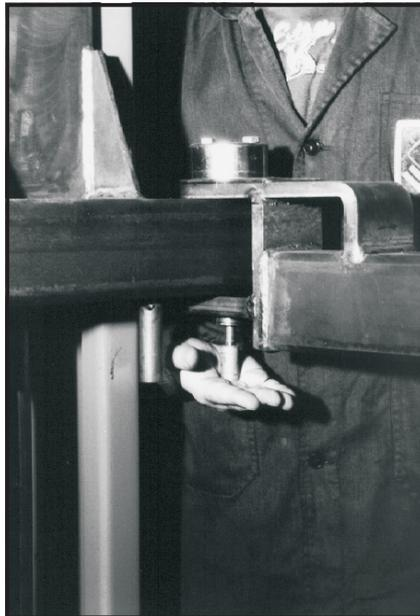
Fig.54 Verifica funzionamento bloccaggio bracci
