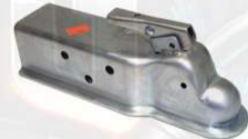
Coupler 2"x3" 10K Ball Size : 2" Capacity : 10,000lbs Color : Zinc Width : 3" Demco
