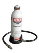
¿Y cómo se hace? Llenar el producto en el bote de aerosol Airspray, introducir el tubo de subida con el adaptador, colocar la válvula con la boquilla rociadora sobre el adaptador y apretarlo a mano con la tuerca de racor. Colocar el bote con la válvula en la estación de llenado; empujar aprox. 2 s hacia abajo. Listo para pulverizar.
