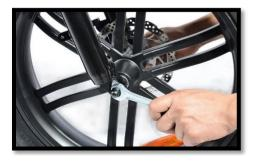
5. Securely tighten the stud bolt.
