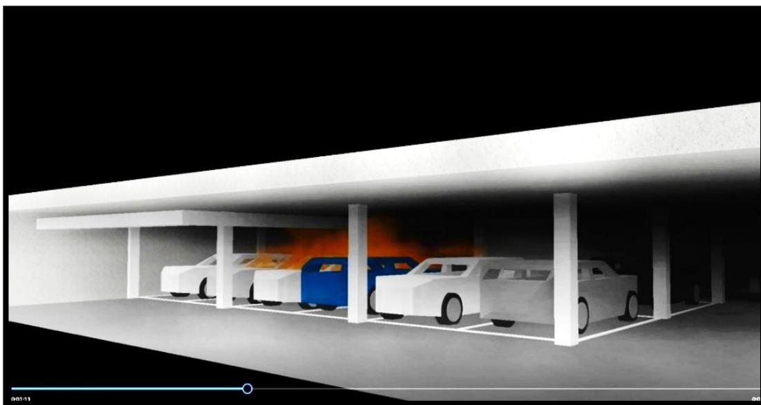
Fig. 1. Simulación computacional de incendio de VE en aparcamiento, sin medidas de protección contra incendios
