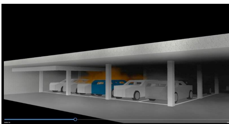
Ilustración 1 Simulación computacional de incendio de VE en aparcamiento sin medidas de protección contra incendios
