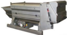
В процессе виноделия собранный виноград из бункера-приемника поступает в дробилку гребнеотделителя, которая может работать в любых необходимых режимах, а именно: а) гребнеотделение; б) гребнеотделение и дробление; в) дробление; г) прохождение целиного винограда без какой-либо обработки. Может поставляться в комплекте с монопомпой, специально оборудованной под дробилку гребнеотделителя.
