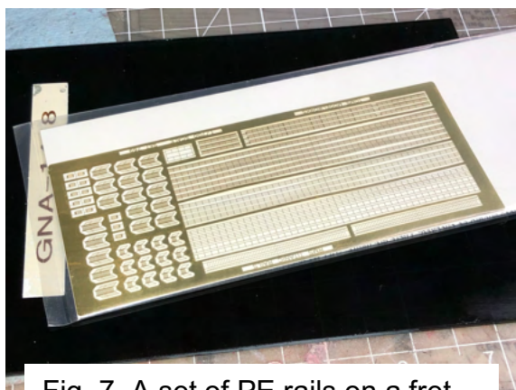
Fig. 7. A set of PE rails on a fret.
