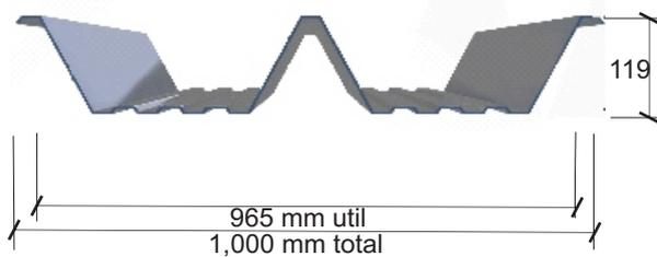
Panel metálico para uso de coberturas, techos, rectos que no necesita mucha estructura de apoyo por sus tres crestas altas, en variedad de colores y espesores. Diseñado para cubrir grandes almacenes, naves, cocheras, angares.
