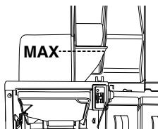
*Do not overfill the hopper.*
