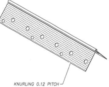
TWIST 3' MAX LAYING LEGS DOWN BOW 1/32 PER FT CAMBER 1/32 PER FT
