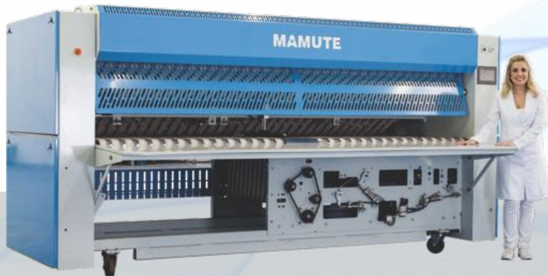
Equipo destinado al pliegue de tejidos planos. Funcionamiento totalmente automático, con sensores para medir y posicionar las ropas a ser plegadas.
