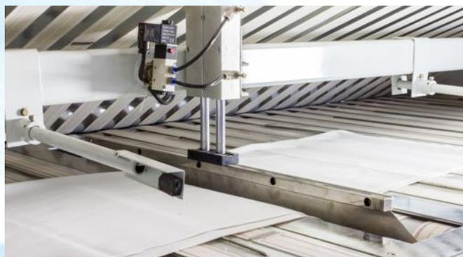
Equipo de alta precisión, con el tercer pliegue siendo ejecutado por sistema de cuchillo, accionado neumáticamente, garantizando el pliegue en el lugar y momento adecuado, garantizando aún que las dimensiones sean siempre las mismas y el pliegue al medio (tercer pliegue) sea ejecutado siempre igual.
