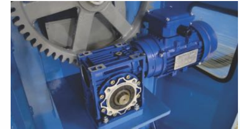
TRANSMISIÓN MECÁNICA CON MOTO-REDUCTOR
