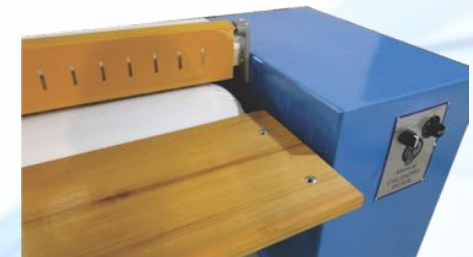
MESA DE ENTRADA DE ROPA Y REJA DE SEGURIDAD
