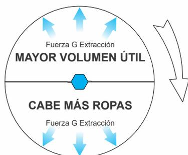
La fuerza centrífuga de los tambores fabricados por Mamute directamente en la chapa, distribuida uniformemente en una superficie cilíndrica, sin enmiendas o soldaduras, no rasga las ropas y ni causa desbalances.
