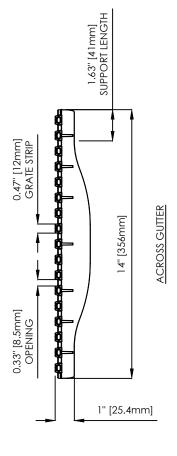
Silentflow DPAS: ALL COMPONENTS ARE CORROSION RESISTANT,
