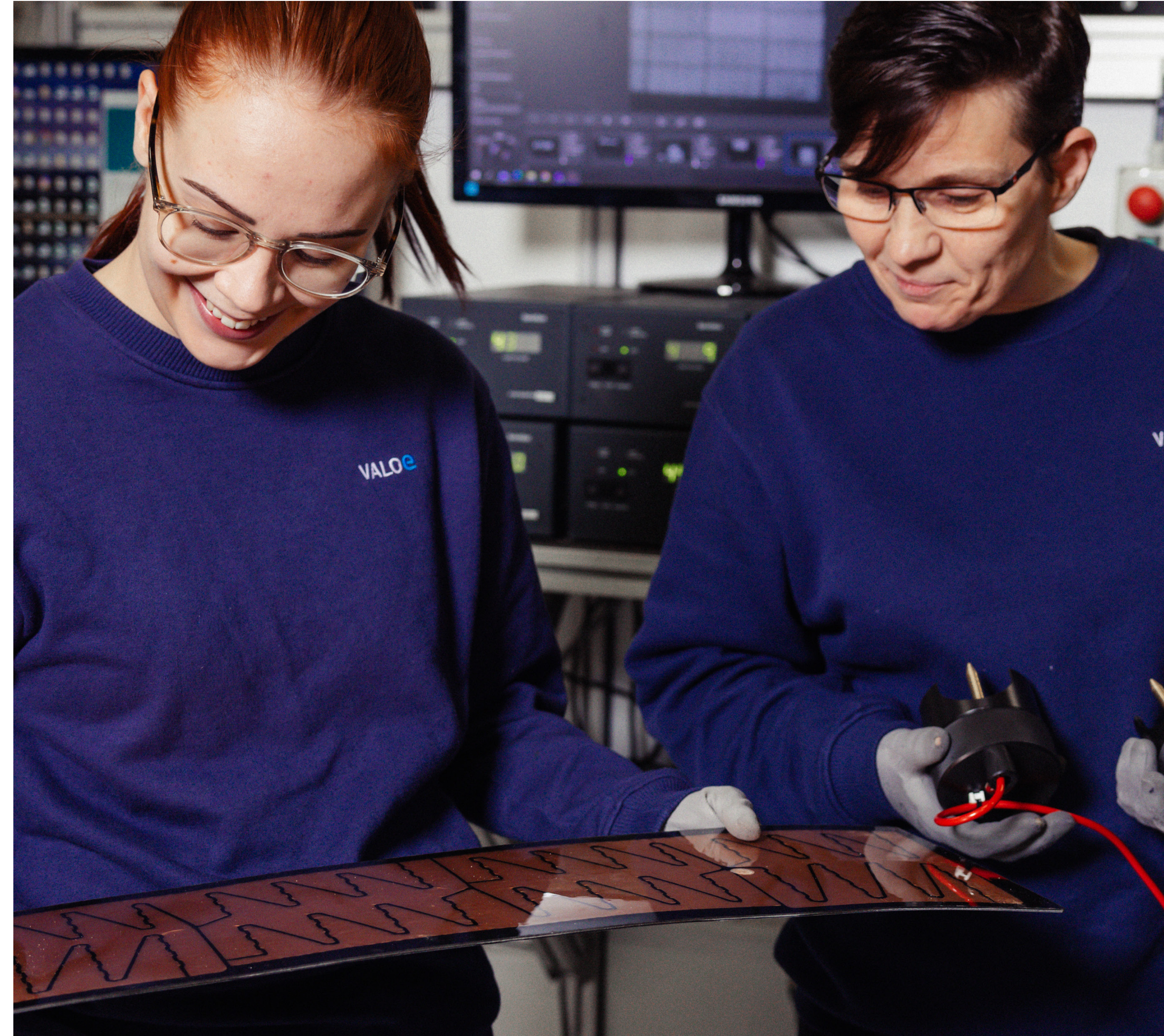
Valoe suunnittelee jokaiseen paneeliin oman "emolevyn". Tämä takaa, että taustajohdinpaneelin teho on muotoonsa ja pinta-alaansa suhteutettuna paras mahdollinen. Oleellista usein hyvinkin pienissä paneeleissa on kennon teho. Valoen IBC-kennot kuuluvat markkinoiden tehokkaimpiin.
