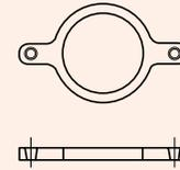
**STACK SUPPORT BRACKETS WITH GASKET**
