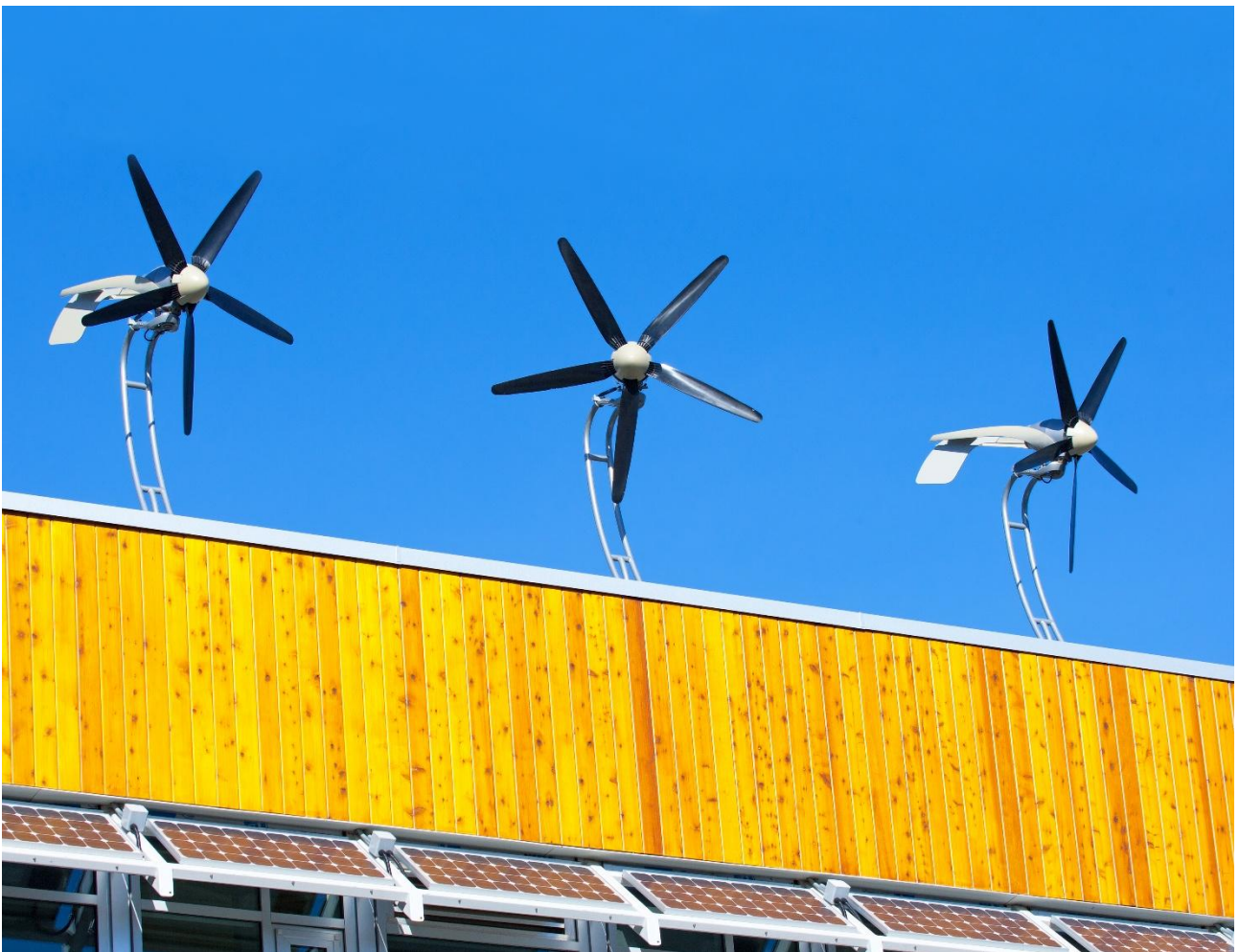
Kuva 2. Vaaka-akselisia potkurityyppisiä pientuulivoimaloita rakennetussa ympäristössä.
