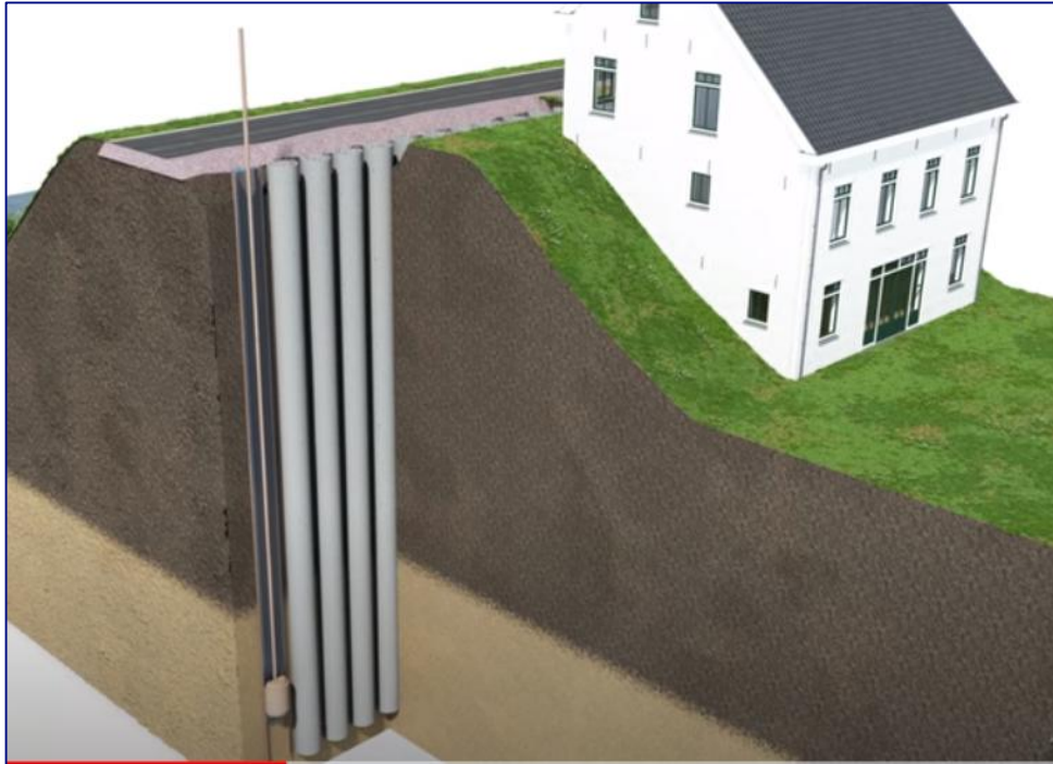
Figuur 2-30 Schematische weergave van een palenwand in de binnenkruin van de dijk
