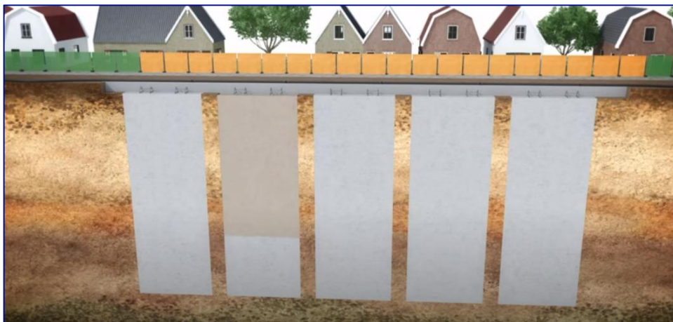
Figuur 2-39 Schematische weergave van wand bestaande uit diepwand-baretten
