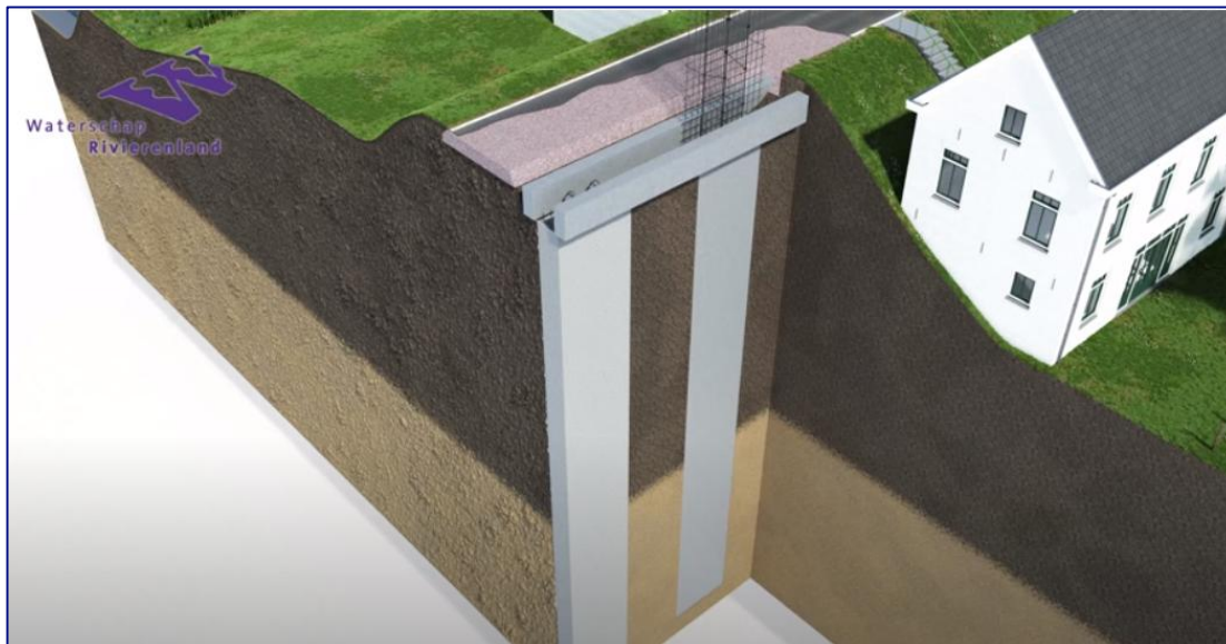
Figuur 2-38 Illustratie van diepwand in uitvoering. De panelen van de diepwand worden tegen elkaar aangestort, zodat er een doorlopende betonnen wand ontstaat in de kruin van de dijk
