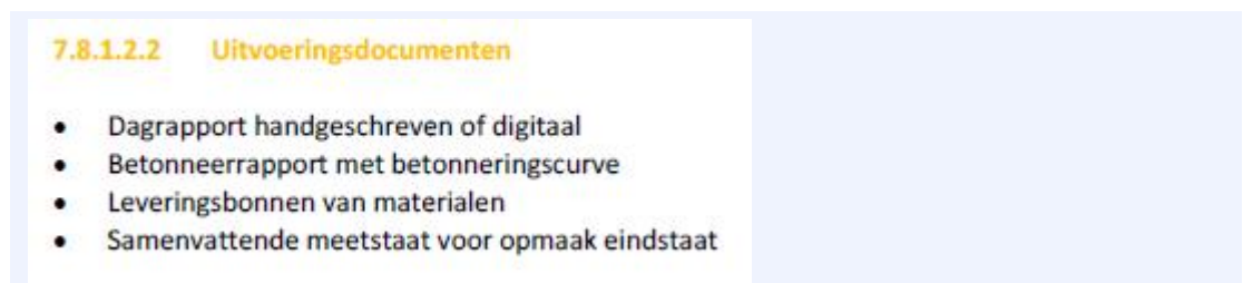
Figuur 2-48 Uitvoeringsdocumenten die volgens het Werkplan worden opgesteld tijdens de realisatie van de boorpalen
