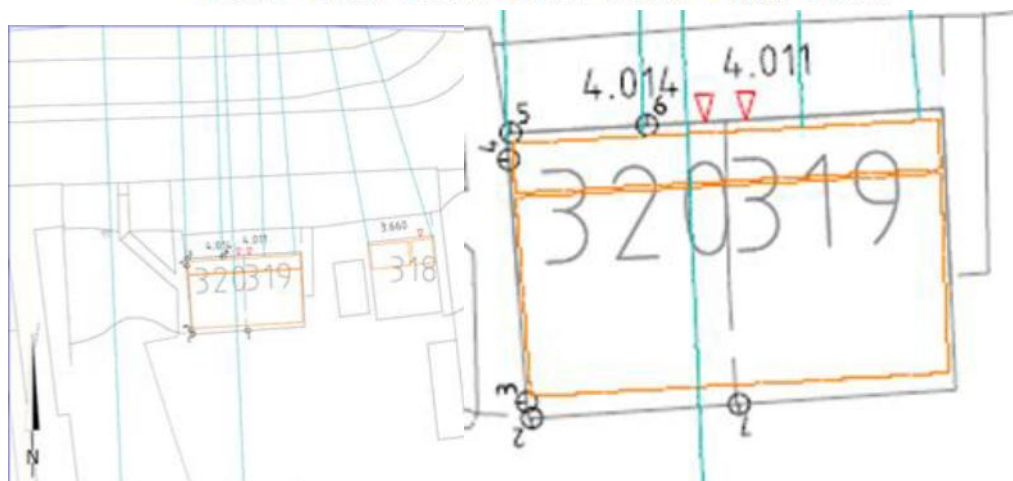
Figuur 3.33 Gemeten zakkings pand Lekdijk 320 WSRL
