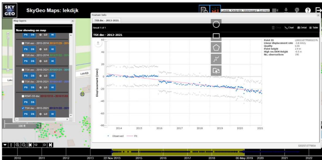
Figuur 3.39 Data van één punt van TSX dsc op pand Lekdijk 327
