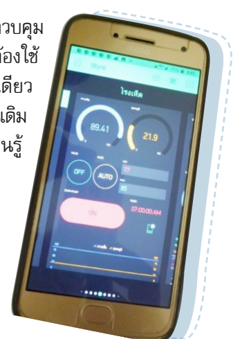
△ ด้านใน เครื่องควบคุม เก็บข้อมูล ความชื้น อุณหภูมิ มีตัวส่งสัญญาณไปยังโทรศัพท์มือถือ
