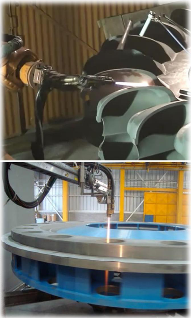
Fig 1. Ejemplos de procesos HVOF para turbinas Pelton y Francis. Procesos: arriba: HVOF JP-5000, abajo: HVOF-DJ-2700.
