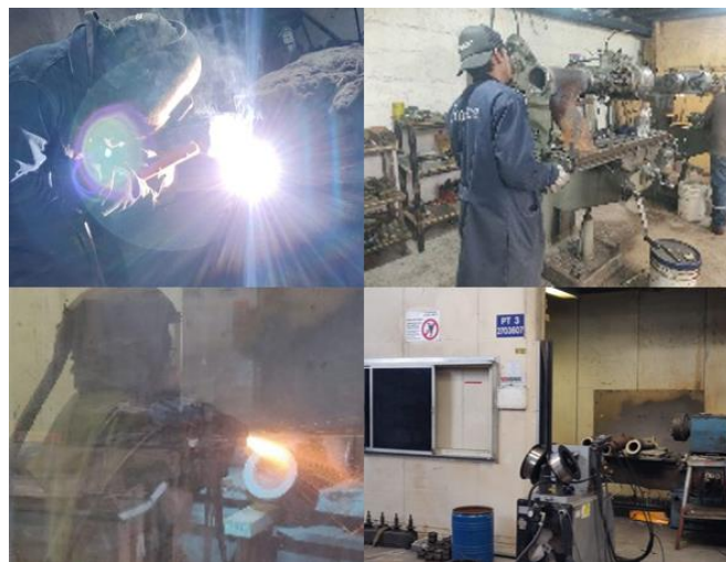
Figura 2 Procesos realizados en la recuperación de las caras de los ductos de escape de motor de generación de combustible pesado.
