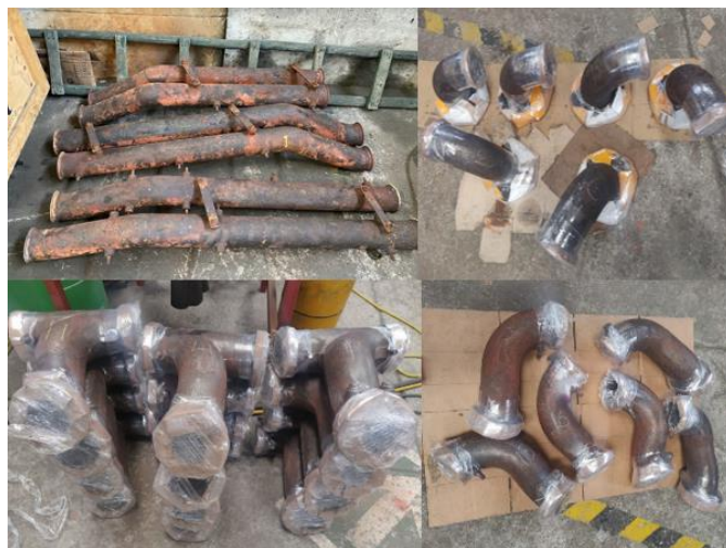
Figura 5 Geometrías básicas del sistema de escape de un motor de generación de combustibles pesados.
