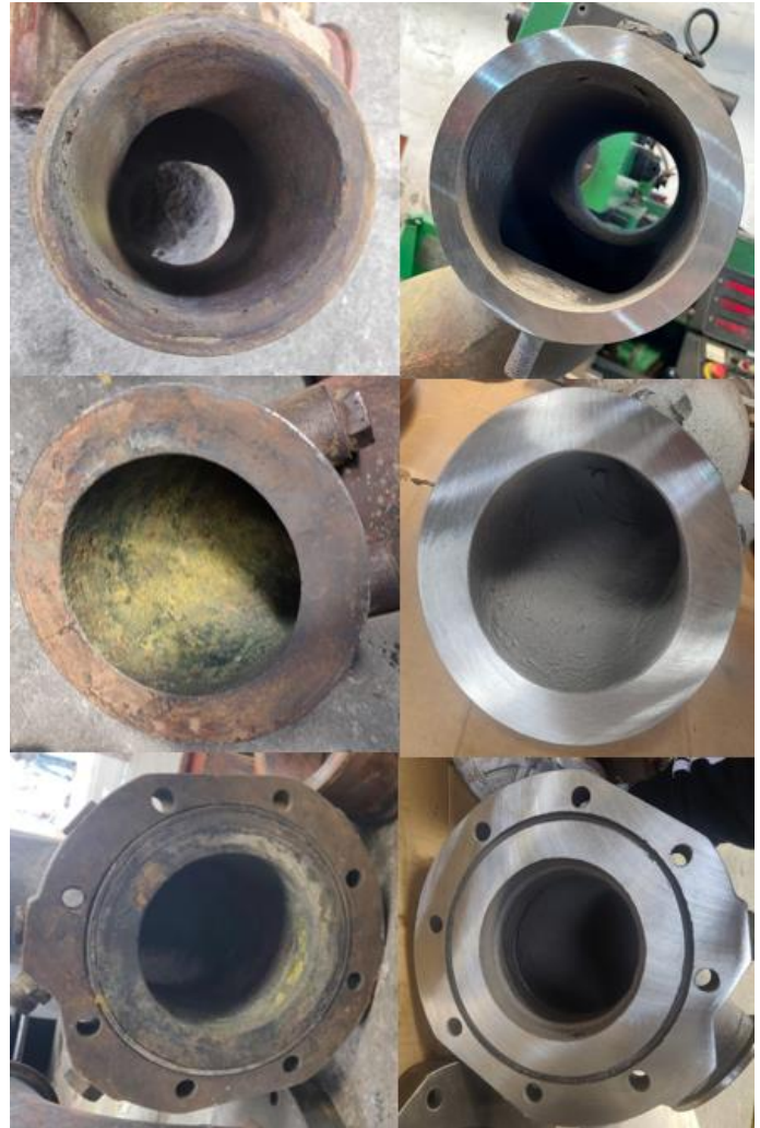
Figura 3 Ductos de escape recuperados por IMETCA de 152x121 mm y 180x121 mm de diámetro.
