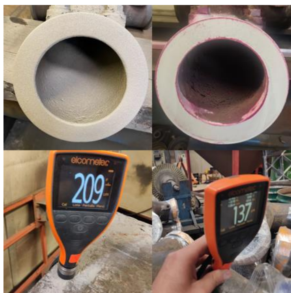
Figura 4 Ensayos realizados a los ductos recuperados por IMETCA.
