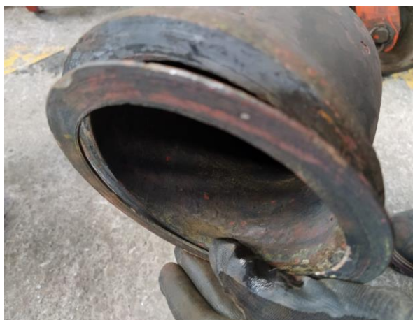
Figura 1 Empaques utilizados para permitir el ajuste de los ductos de escape y evitar fugas de gases.
