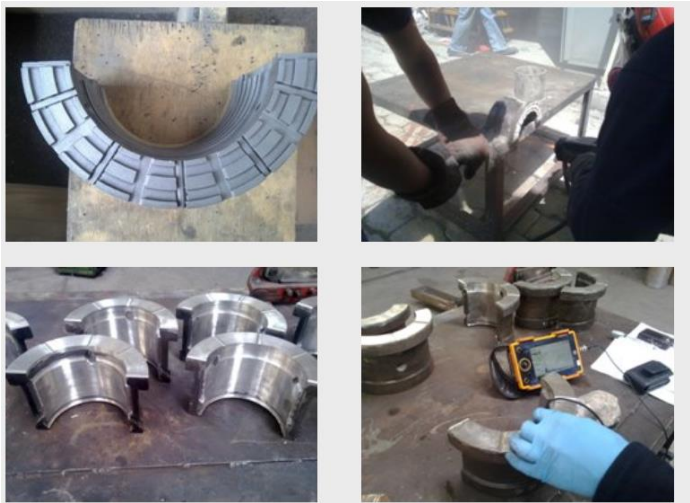
Fig. 1. (superior izquierda) chumacera a la cual se ha removido el babbitt por calentamiento y limpieza química y mecánica. (superior derecha) Proceso de metalización con torcha de arco eléctrico. (inferior izquierda) maquinado final a medida y tolerancia especificada por la aplicación. (inferior derecha) control de calidad por ultrasonido y corrientes inducidas.
