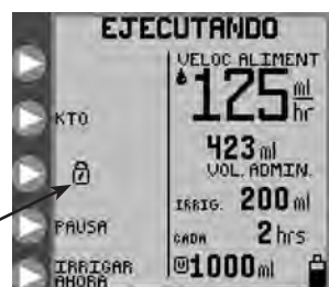
Figura 17. El candado indica que la bomba está en modo BLOQUEAR PANTALLA.
