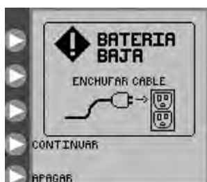
Figura 31. Pantalla de error Bateria baja. Indica que es necesario cargar inmediatamente la batería.
