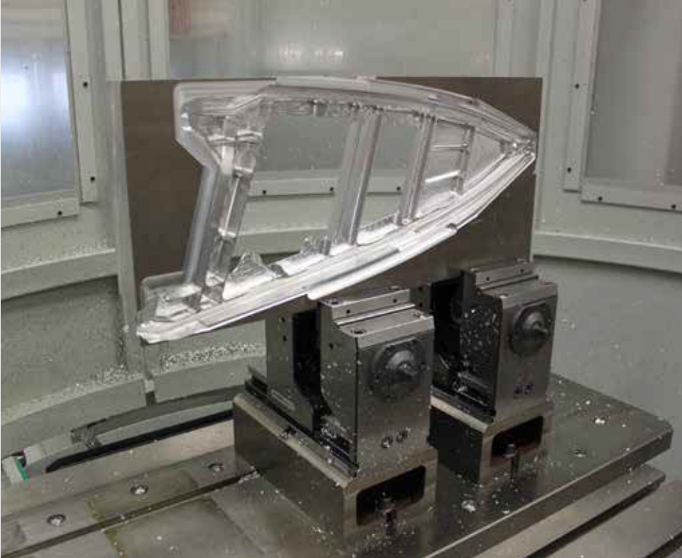
grepos-5X Mit Standard-Aufsatzbacke auf Unterbau zum Spannen von Flugzeugteilen grepos-5X With standard top jaw on substructure for clamp aeroplan workpieces
