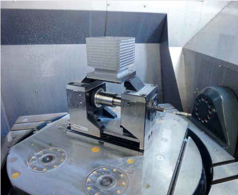
grepos-5X Mit Aufsatzbacke 5A auf DMG Maschine, direkt gespannt mit 2 Aufnahmebolzen auf Nullpunkt-Spannsystem grepos-5X With top jaw 5A on a DMG machine, directly clamped with 2 locating bolts on a zero point system
