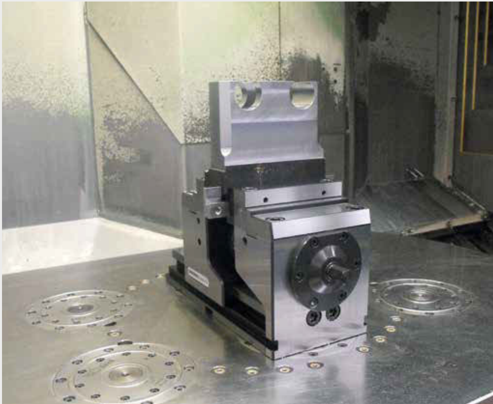
grepos-5X-S/265 Mit Standard-Aufsatzbacken und Stufenbacke grip 8 mm mit T-Nut. Positionierleiste als Anschlag für das Rohmaterial grepos-5X-S/265 With standard top jaws and stepped grip jaw 8 mm with T-slot. Positioning strip serves as stop for the blank
