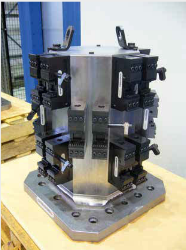
solinos 40 24 solinos 40 auf Kreuzturm montiert solinos 40 24 solinos 40 mounted on a cross tombstone
