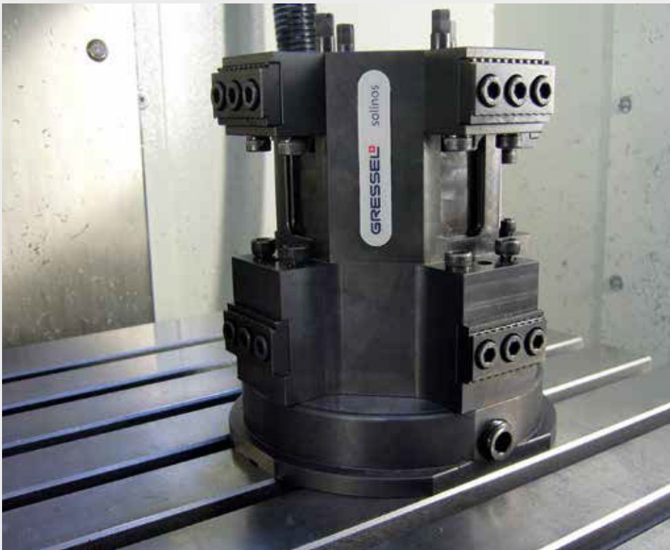
solinos 40-4V-IT Monoblockturm gespannt auf gredec rund solinos 40-4V-IT Monoblock tombstone clamped on round gredec
