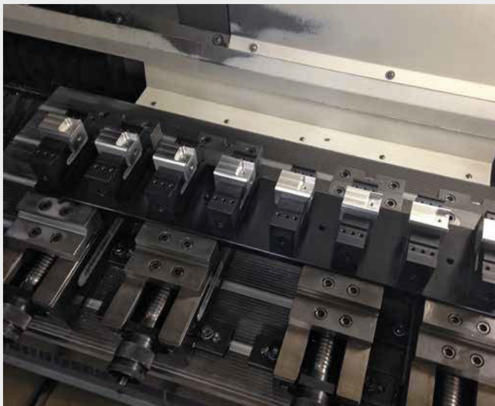
solinos 40 Spannpalette 8-fach mit 8 solinos 40 montiert solinos 40 Clamping pallet 8-fold with 8 solinos 40 mounted
