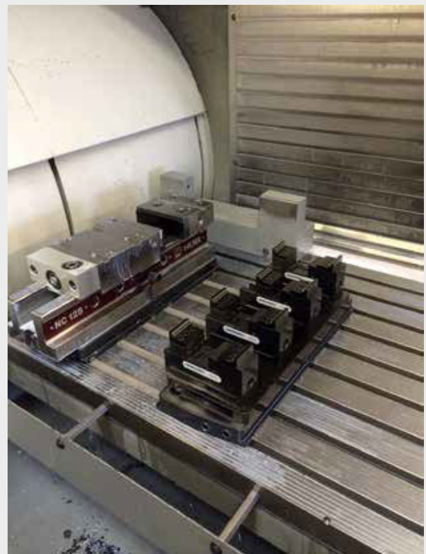
solinos 40 Spannpalette 4-fach mit 4 solinos 40 montiert auf gredoc eckig solinos 40 Clamping pallet 4-fold with 4 solinos 40 mounted on rectangular gredoc
