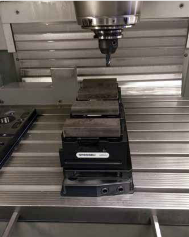
solinos 40 Spannpalette 4-fach mit 4 solinos 40 montiert auf gredec eckig solinos 40 Clamping pallet 4-fold with 4 solinos 40 mounted on rectangular gredec
