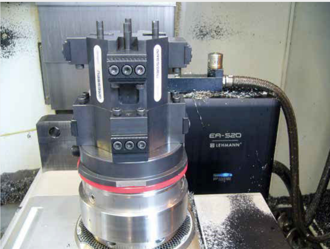
solinos 40-4V-IT Montiert auf Lehmann Teilapparat 520 solinos 40-4V-IT Mounted on Lehmann 520 component part
