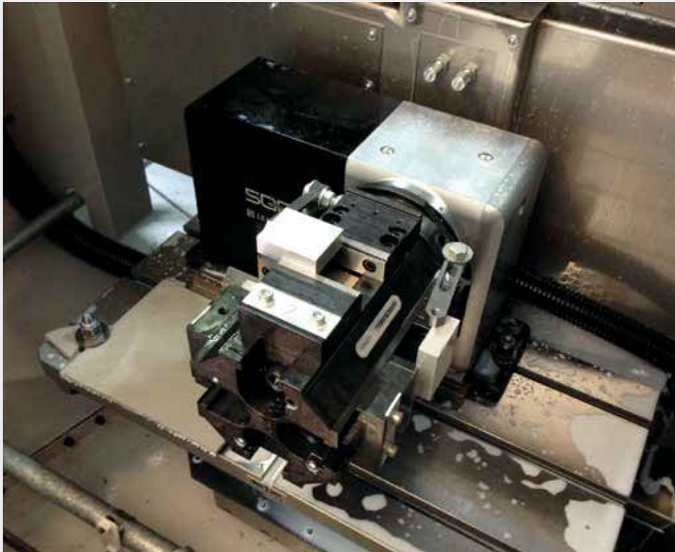
solinos 65-4V-IT 4-fach Monoblockturm zur Mehrfachspannung auf Lehmann Teilapparat solinos-65-4V-IT 4-fold monobloc tombstone for multiple clamping on Lehmann component part
