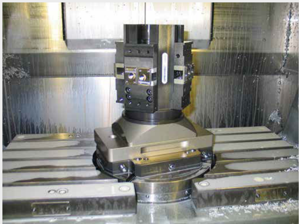
solinos 65-4V-IT 4-fach Monoblockturm gespannt auf gredoc Konsole und gredoc NRS 3-fach Ø280 solinos 65-H 4-fold monobloc tombstone clamped on a gredoc console and gredoc NRS 3-fold Ø280
