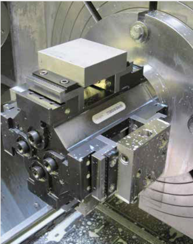
solinos 65-4V-IT 4-fach Monoblocktrum zur Mehrfachspannung auf Hermle Maschine 4-fold monobloc tower for multiple clamping on a Hermle machine
