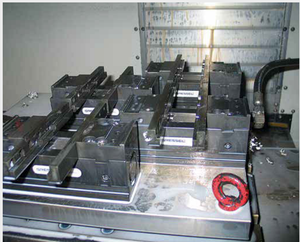
solinos 65-H solinos hydraulisch mit Spezialbacken auf einer Grundplatte versetzt angeordnet solinos 65-H Hydraulic solinos arranged offset on a base plate using special jaws
