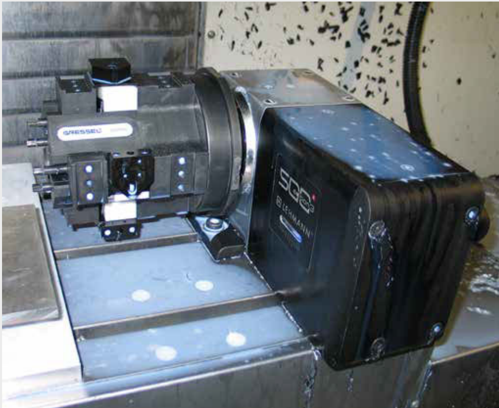
solinos 65-4V-IT 4-fach Monoblockturm gespannt auf GRESSEL gredoc rund und Lehmann 4. Achse solinos 65-H 4-fold monobloc tombstone clamped on a GRESSEL gredoc round and Lehmann 4th axis
