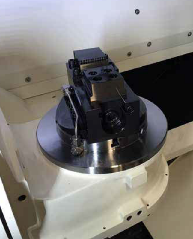
solinos 100-H Mit werkstückspezifischen Backen für 1. + 2. Seitenbearbeitung auf einer DMG Milltap 700 solinos 100-H With workpiece specific jaws for 1st and 2nd side machining on a DMG MILLTAP 700
