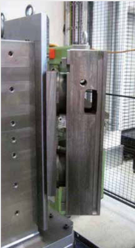
gredoc rund 2 gredoc rund auf GRESSEL Aufspannturm. Direktspannung Grundkörper gripos 160 (60 kg) gredoc round 2 gredoc round mounted on a GRESSEL tombstone. Direct clamping of gripos 160 tool body (60 kg)
