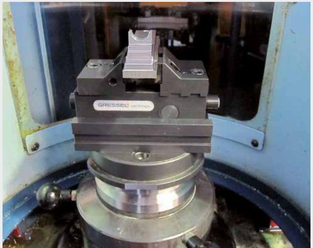
gredoc rund + centrinos 65-5A gredoc rund mit centrinos 65-5A montiert auf einer Matsuura Palette gredoc round + centrinos 65-5A gredoc round with centrinos 65-5A mounted on a Matsuura pallet
