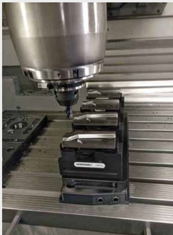
gredoc eckig Spannpalette 4-fach mit 4 solinos 40 montiert gredoc rectangular Clamping pallet 4-fold with 4 solinos 40 mounted
