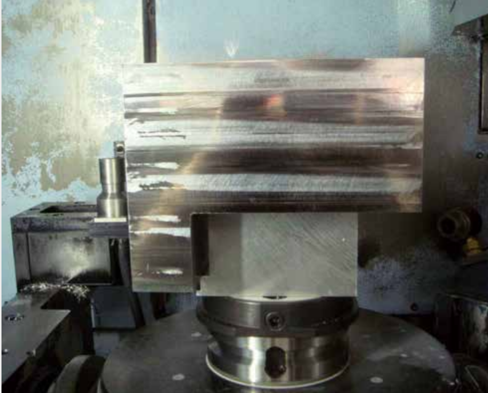
gredoc rund gredoc rund auf Matsuura Palette. Werkstück-Direktspannung (48 kg) gredoc round gredoc round mounted on a Matsuura pallet. Direct clamping of workpiece (48 kg)
