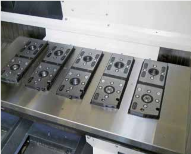
gredec eckig 5 gredec eckig auf DMG Maschinentisch mit Schutzabdeckung der Nuten gredec rectangular 5 gredec rectangular mounted on a DMG machine table with protective cover plates
