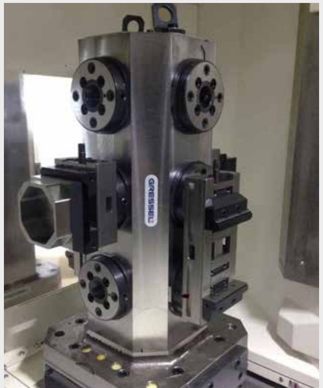
gredec rund 12 gredec rund montiert auf einem GRESSEL Aufspannturm gredec round 12 gredec round mounted on a GRESSEL tombstone
