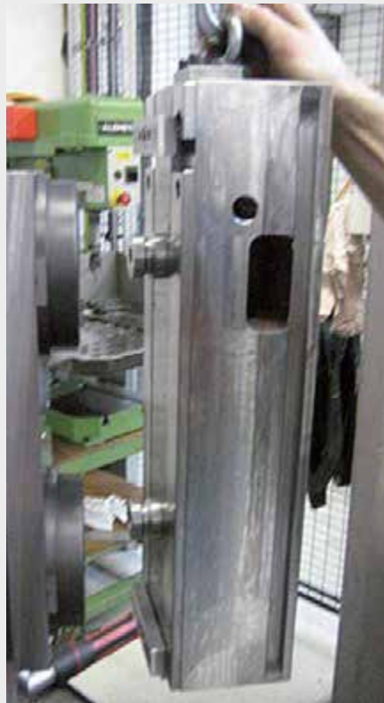
gredoc rund 2 gredoc rund auf GRESSEL Aufspannturm. Direktspannung Grundkörper gripos 160 (60 kg) gredoc round 2 gredoc round mounted on a GRESSEL tombstone. Direct clamping of gripos 160 tool body (60 kg)
