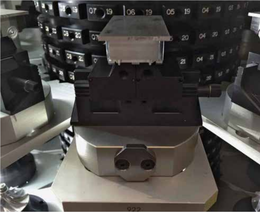
C1 40 Mit Wendebacken grip auf Paletten einer Häberle Automation an einer FANUC Robodrill Maschine C1 40 With reversible grip jaws on palletized with Häberle automation on a FANUC Robodrill machine
