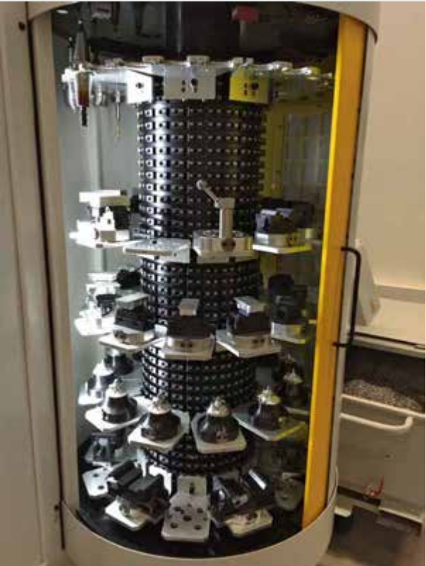
C1 40 C1 40 mit Wendebacken grip in einer Häberle Automation an einer FANUC Robodrill Maschine C1 40 C1 40 with reversible jaw in a Häberle automation on a FANUC Robodrill machine
