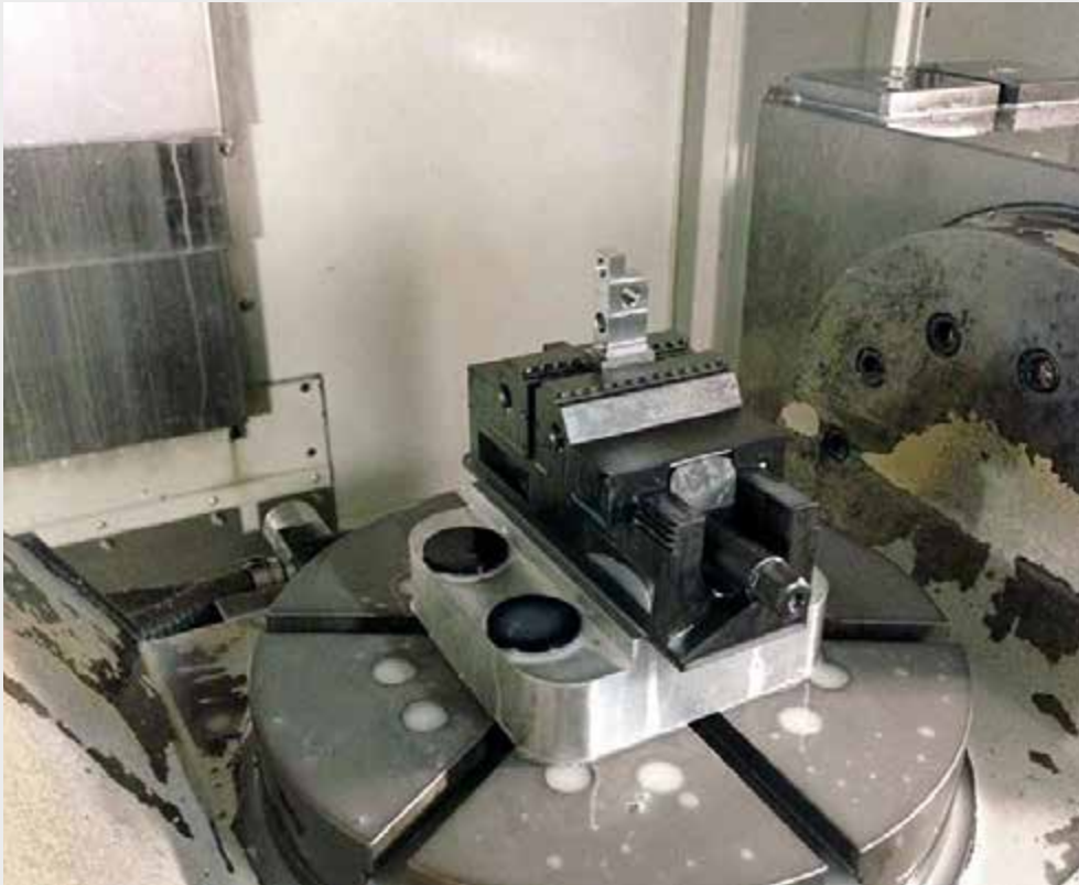
C1 65 grip Auf Unterbau C1 65 grip On base support
