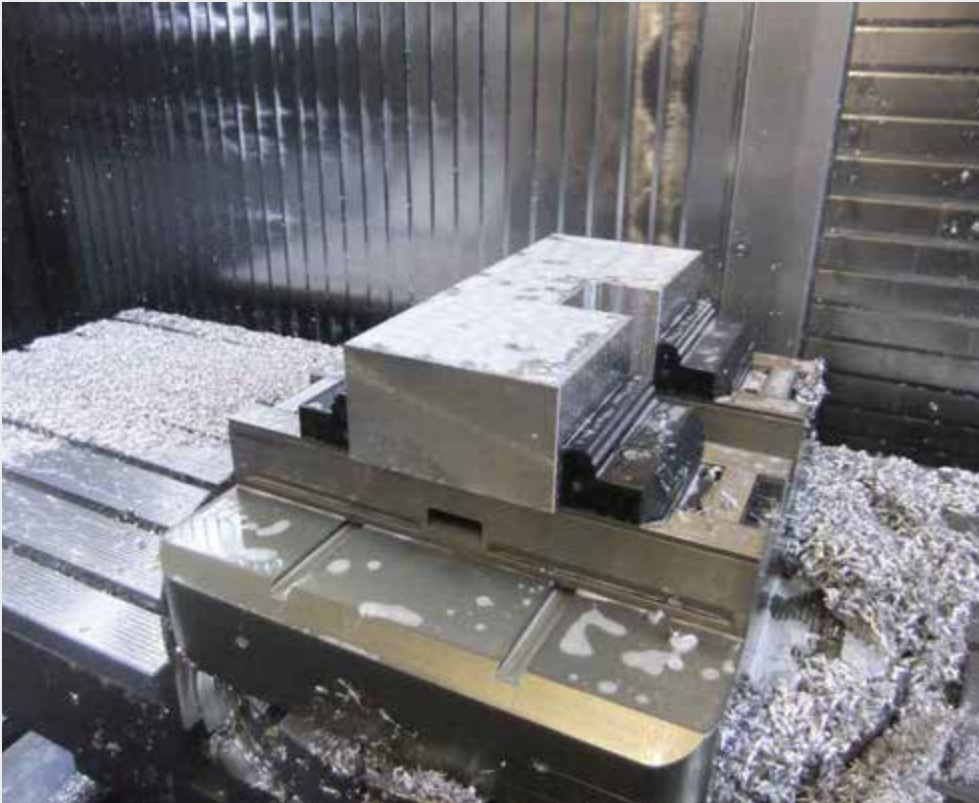
C2 160 L-480 2 Stück mit Wendebacke grip auf Unterbau C2 160 L-480 2 pieces with reversible grip jaw on substructure
