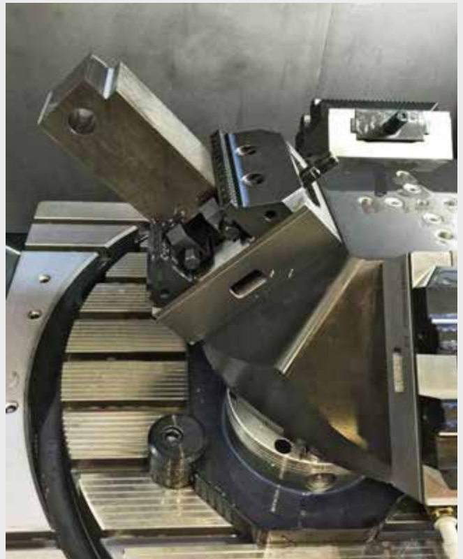
C2 125 L-160 Mit 6-fach Backensystem für Werkstück Komplettbearbeitung C2 125 L-160 With 6-fold jaw system for workpiece complete machining
