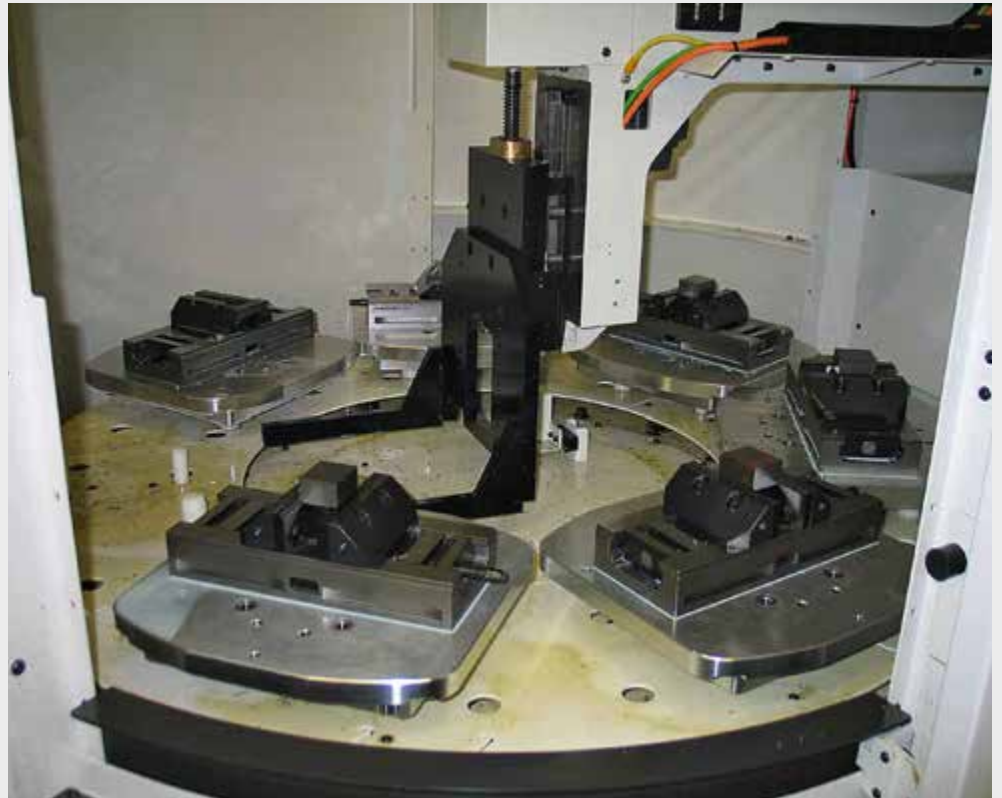
C2 125 L-300 Mit 5-Achs Backe Breite 125 und Stufenbacke grip 5 mm in einer Mikron Automation C2 125 L-300 With 5-axis jaw width 125 and stepped grip jaw 5 mm in a Mikron automation
