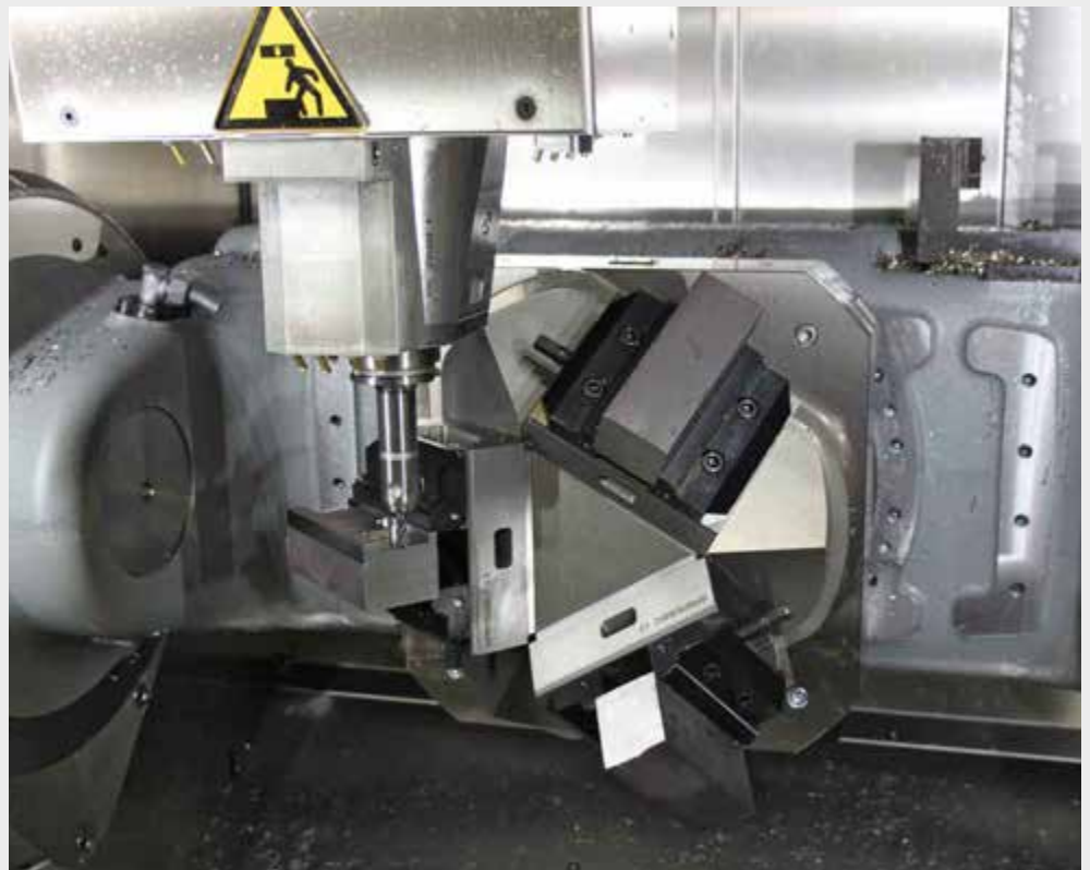
C2 125 L-160 Mit Wendebacken grip auf 3-fach Pyramide C2 125 L-160 With reversible grip jaw on a 3-fold pyramid
