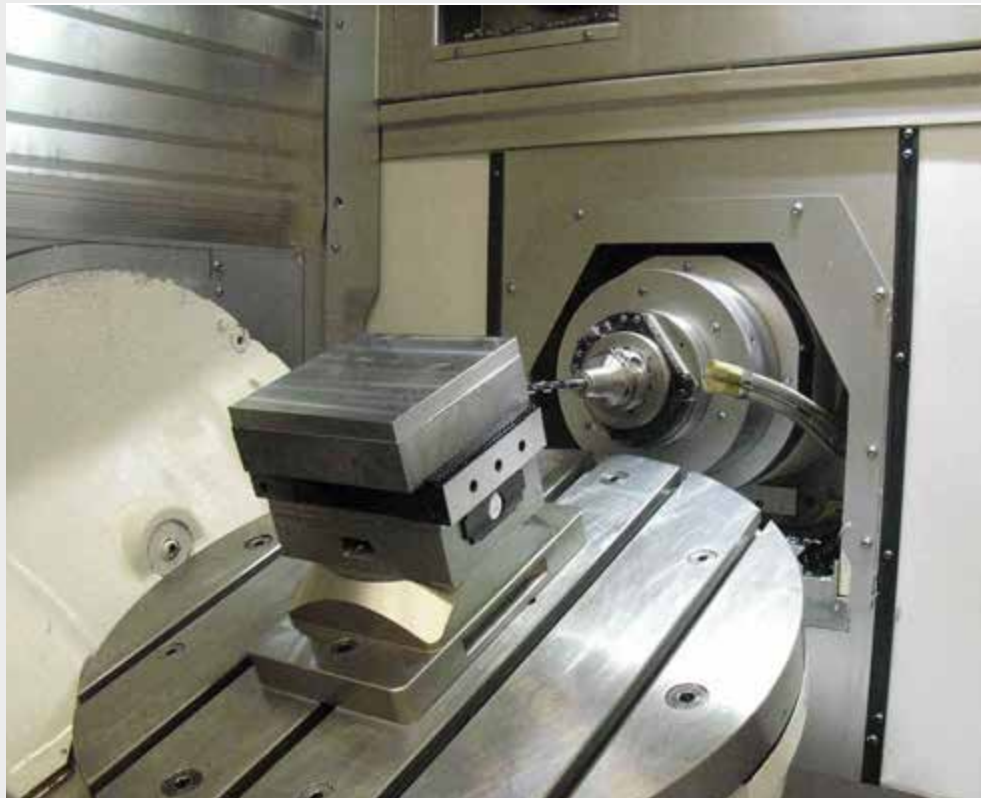
C2 125 L-160 Mit Wendebacken grip auf Konsole montiert C2 125 L-160 With reversible grip jaw mounted on console
