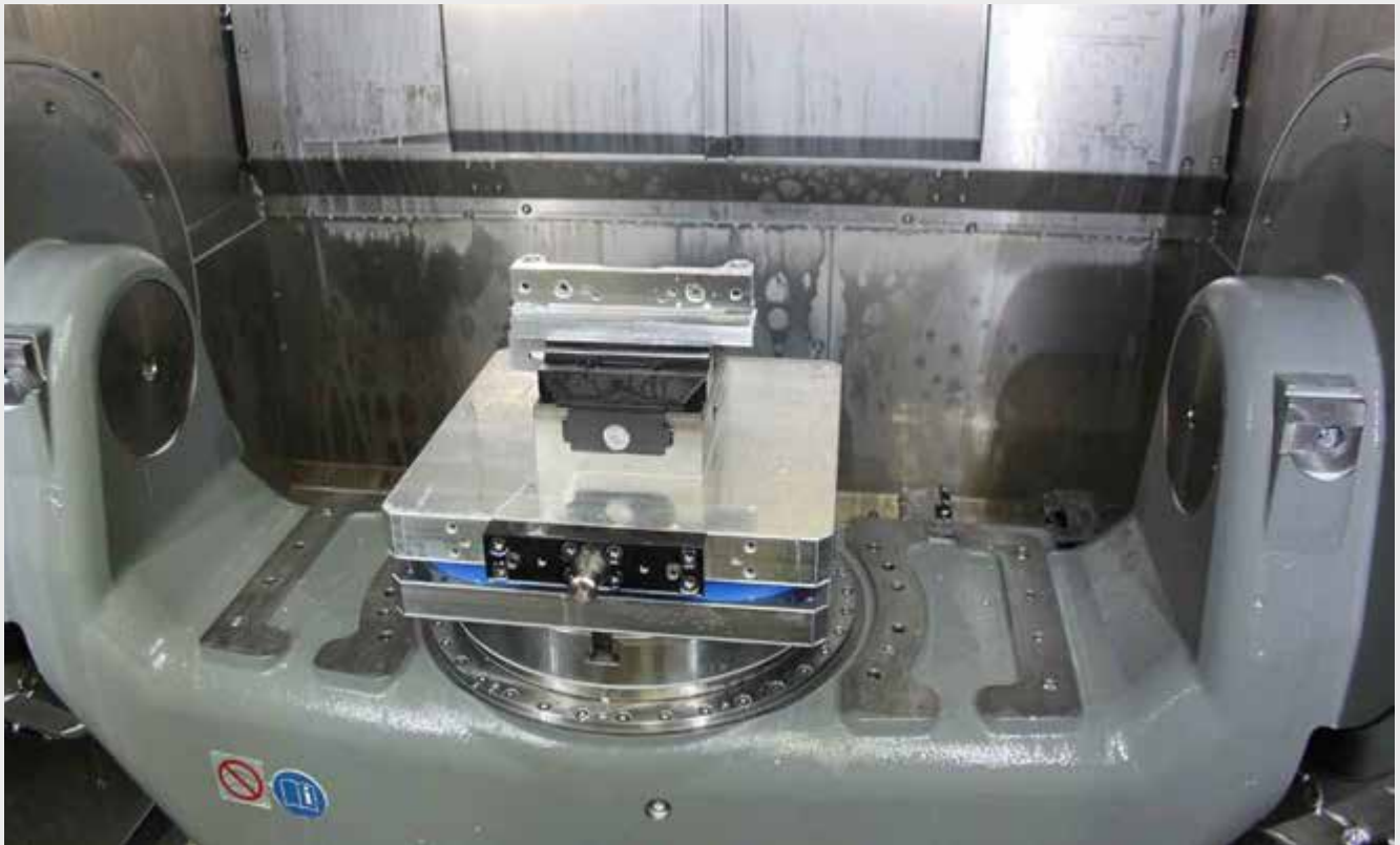
C2 125 L-160 Mit Wendebacken grip auf HERMLE Maschine mit Palettenautomation C2 125 L-160 With reversible grip jaw on a HERMLE machine with pallet automation
