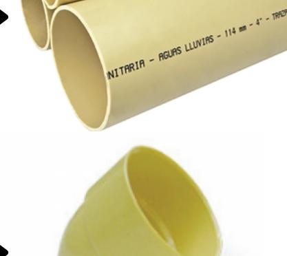
**CODO SANITARIO 45°:** Los codos de 45° en instalaciones sanitarias son accesorios de tubería que permiten cambiar la dirección del flujo en un ángulo de 45 grados. Son comúnmente usados en sistemas de evacuación de aguas residuales debido a que ofrecen una curva más suave en comparación con los codos de 90°, lo que reduce la posibilidad de atascos y facilita el flujo del agua y desechos
