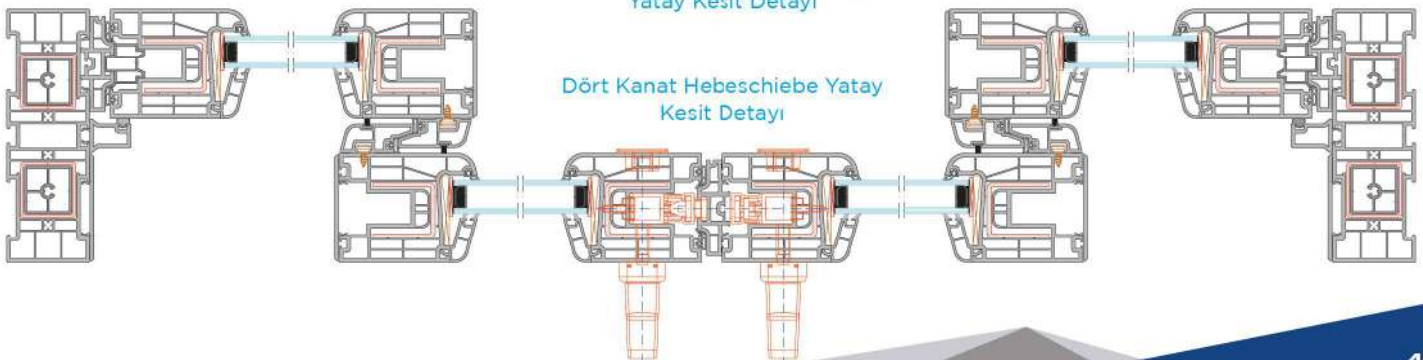
Alın Alına Kanat - Kanat Birleşim Yatay Kesit Detayı
