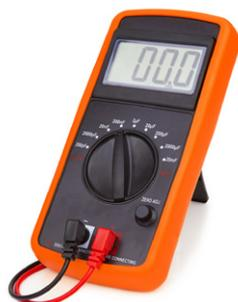
El multímetro es una herramienta muy necesaria ya que permite una rápida medición del voltaje, continuidad, corriente y amperaje para la evaluación de circuitos eléctricos, presentes en sensores y actuadores.
