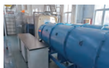
通风机远程控制系統测试试验平台
