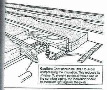
FIGURE A.5.4.2(e) Insulation Recommendations — Arrangement 5.
