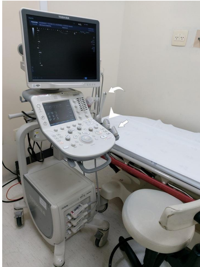
IMAGEM 7: Aparelho de ultrassonografia, com três transdutores acoplados, o linear (seta), convexo (cabeça de seta) e endocavitário (seta curva).
