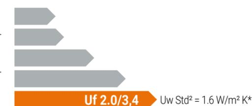
Valore calcolato secondo EN 10077 per un serramento 1 anta 1537x2340 dotato di vetro con Ug 1.0 W/m²K\* con canalina bordo caldo
