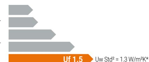
Valore calcolato secondo EN 10077 per un serramento 1 anta 1535x1480 dotato di vetro con Ug 1.0 W/m²K\* con canalina bordo caldo
