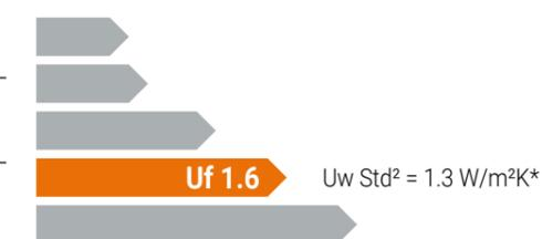
Valore calcolato secondo EN 10077 per un serramento 1 anta 1535x1480 dotato di vetro con Ug 1.0 W/m²K\* con canalina bordo caldo
