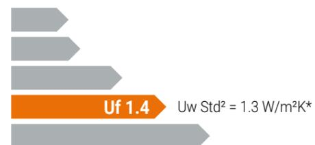
Valore calcolato secondo EN 10077 per un serramento 1 anta 1535x1480 dotato di vetro con Ug 1.1 W/m²K\* con canalina bordo caldo
