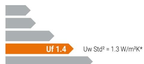
Valore calcolato secondo EN 10077 per un serramento 1 anta 1535x1480 dotato di vetro con Ug 1.1 W/m²K\* con canalina bordo caldo
