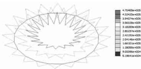
图 7 非地震组合作用下环索及拉杆应力/kPa
