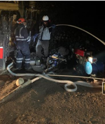
PRUEBA DE BOMBEO A CAUDAL CONSTANTE
