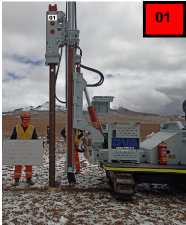
HINCADORA, SANROCK, Modelo SRP536, 1500 J, Longitud del martillo 5m, año 2024
