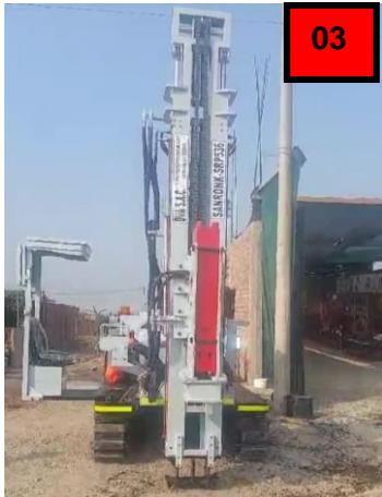
HINCADORA, SANROCK, Modelo SRP536, 1500 J, Longitud del martillo 5m, año 2024
