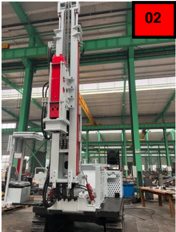
HINCADORA, SANROCK, Modelo SRP536, 1500 J, Longitud del martillo 5m, año 2024
