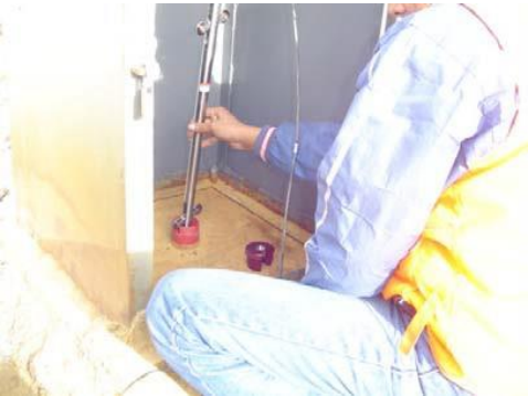
INSTALACIÓN y MONITOREO DE INCLINÓMETROS (ASTM D4429)
