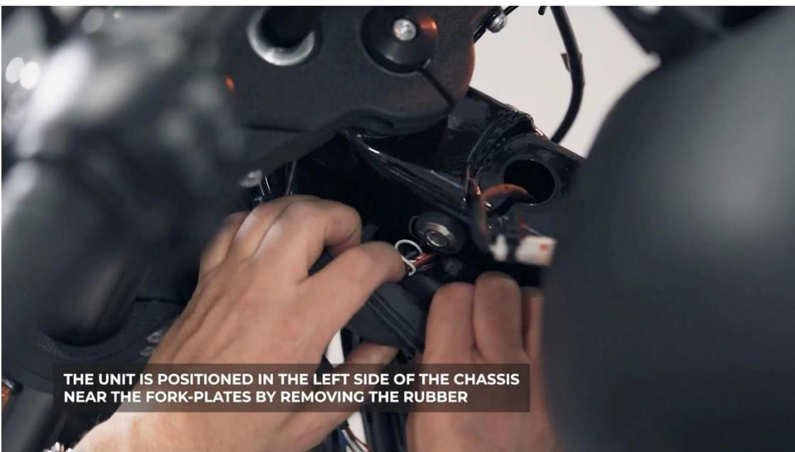
**THE UNIT IS POSITIONED IN THE LEFT SIDE OF THE CHASSIS
