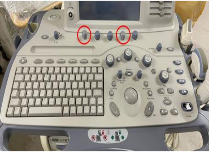
Şekil 2 (USG cihazının eksik ayar tuşları tamamlanması)
