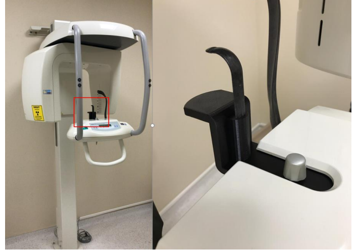
Şekil 3 (Panoramik Röntgen Cihazının kullanıma bağlı sık kırılan çene dayama aparatı)
